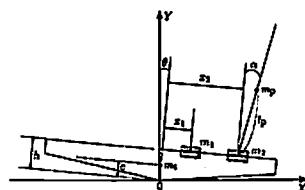
図1 シーソー+倒立振子システムの概略図
