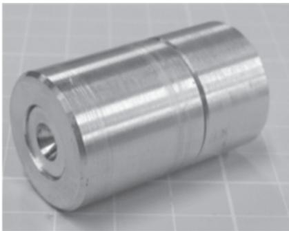
図5. 学生が製作したすきまばめ部品の組み合わせ
