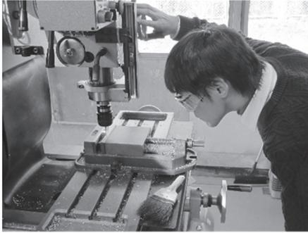
図 9. フライス盤による加工の様子
