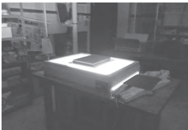
図5 製版機による紫外線露光（写真製版）作業
