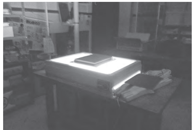
図5 製版機による紫外線露光（写真製版）作業
