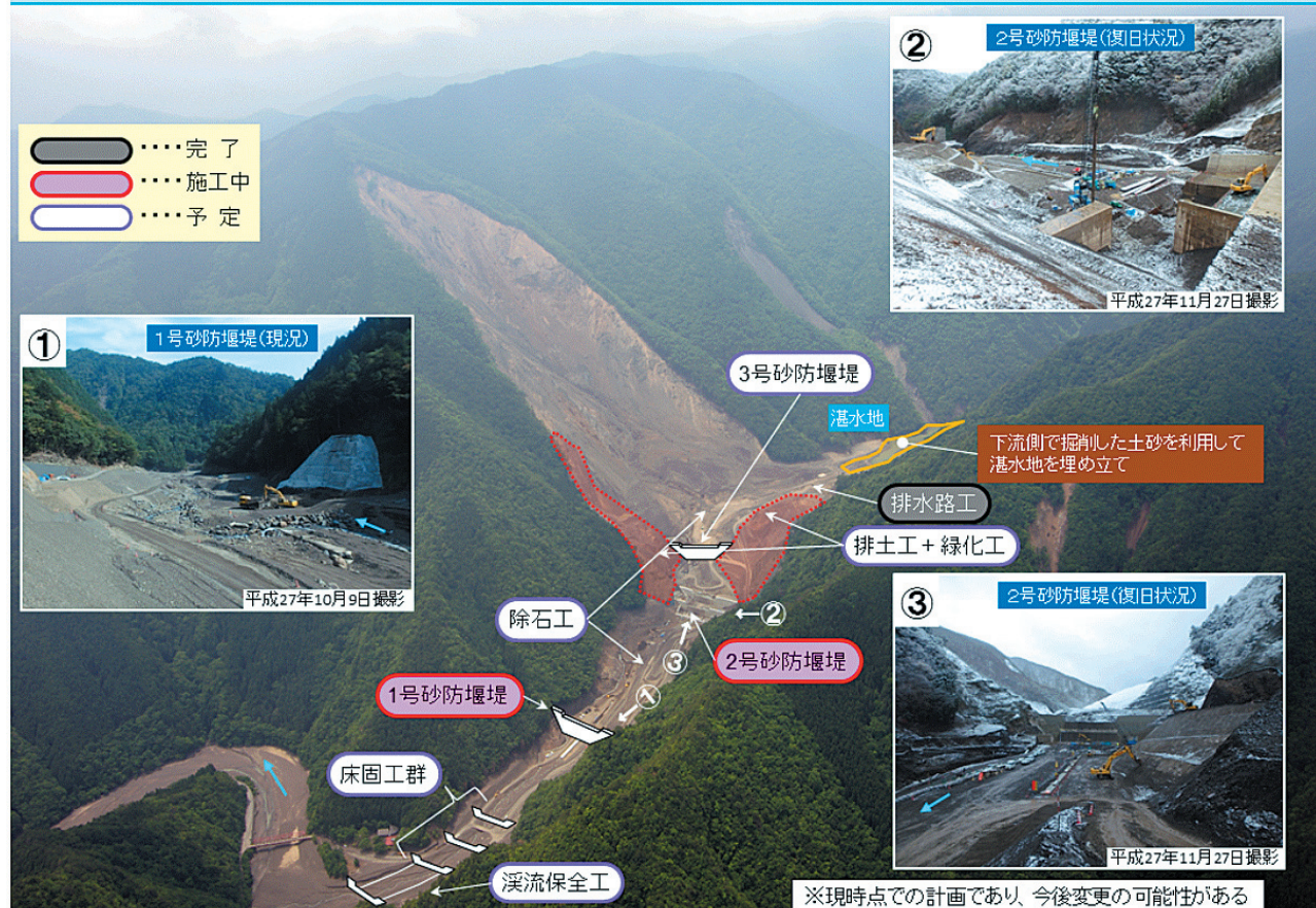
図1 赤谷地区の整備状況。2014年8月の出水等で被災した2号砂防堰堤の復旧はほぼ完了し、現在は1号砂防堰堤の整備にも着手している。
