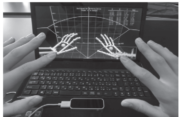
図4 LEAPMOTIONセンサーと画面に表示された手のモデル
