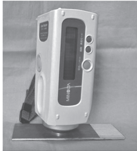
図2 色彩計による色の測定
