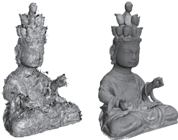
図 3. 計測データを位置合わせした 3D データ(左)とメッシュ化処理の完了した 3D データ(右)
