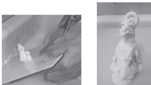
図5 流水で剥離させる。右はバリのある状態
