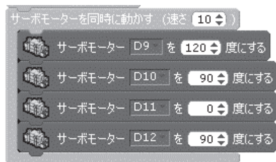
図6 二足歩行を制御するプログラムの核の部分
