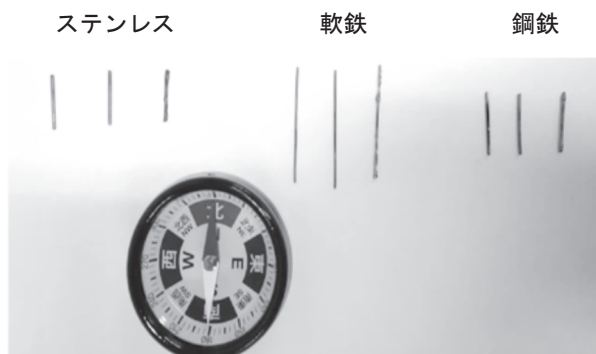
図5 加熱後のステンレス、軟鉄、鋼鉄を地磁気の南北方向に静置して磁化している様子（それぞれ左からアルコールランプ、ガスバーナー、酸素バーナーの順で並べている）
