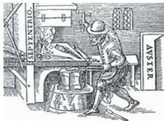
図4 De Magnete 「磁石論」の挿絵 加熱した鉄をたたいて磁化しているところ Project Gutenberg 6) より引用
