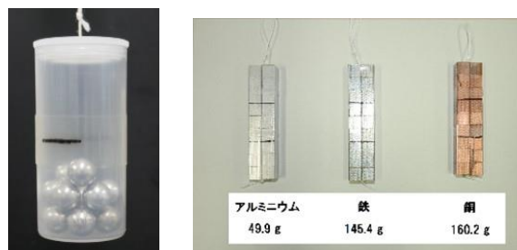
図1 フィルムケースに鉄球を入れた水に沈める物体と3種類の金属ブロックを繋げた水に沈める物体
