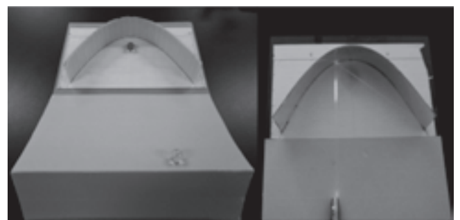
図 2：作成した実験1の教材：斜面上のどの点からビー玉を転がしてもビー玉は必ず焦点を通る(左)。同様の実験を、レーザーポインターを用いて行う(右)。
