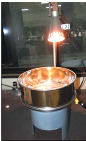
図8. ツルグレン装置：熱と光を避けて動物は下へ落ちて採集される
