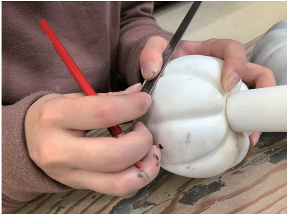
図12 原型を2分割する様子
