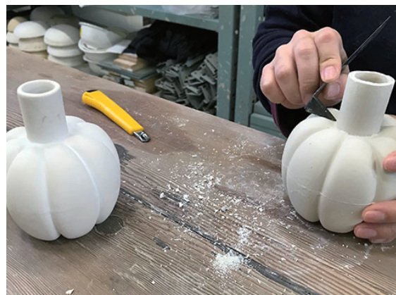
図20 成形物の修正・仕上げ
