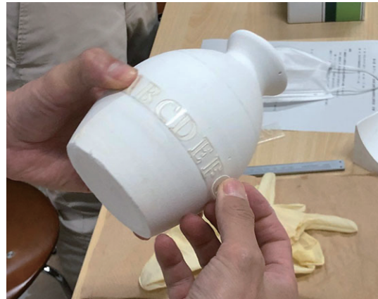
図3 石膏と樹脂のハイブリッド原型
