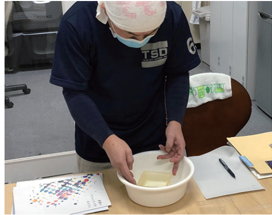
図2 樹脂型をお湯で柔らかくし、原型師がマチを設計する様子
