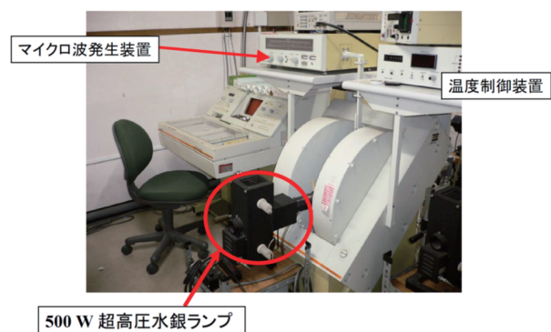
図2 日本電子製JES-RE2X型電子スピン共鳴分光装置
